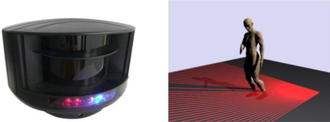
Figure 5. Les scanners lasers range (RLS, BEA LZR-i100 : à gauche) sont utilisés pour produire un « rideau » horizontal et parallèle au sol permettant la détection de la position des pieds et le suivi du déplacement des sujets dans le cadre de marche (à droite) [45].
