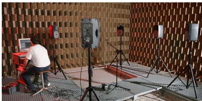
Grande chambre anéchoïque du laboratoire d'acoustique (ULg)
